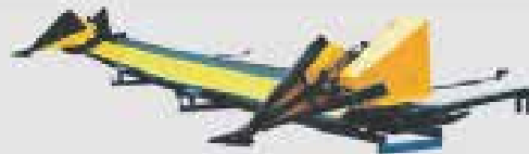
Пристрій "FLEX" "ETTARO" для збирання сої та бобових
