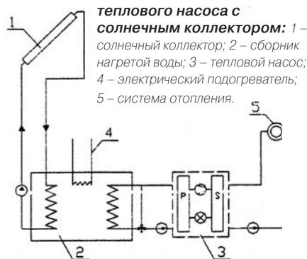
нивается отопительным коэффициентом, который показывает, сколько теплоты передается высшему источнику теплоты на единицу затраченной на его работу энергии. Эта величина больше единицы (2...5), в чем и состоит выгода получения теплоты, причем, чем выше температура низшего источника теплоты и ниже температура высшего источника, тем больше отопительный коэффициент.
